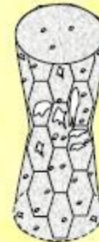
Rupture par cavitation Fluage secondaire
